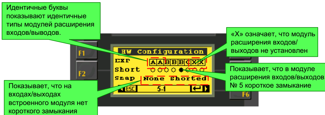
Рисунок 13. Информационный режим: конфигурация аппаратной части
