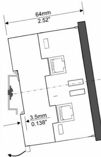
Рисунок 5. Как вставляется контроллер в шину DIN
