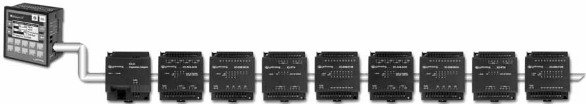
Рисунок 9. Встраивание модулей расширения ввода/вывода
